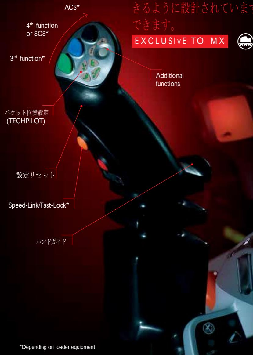
コントローラーはローダーを操作するうえで重要になってきます。それぞれのトラクターにマッチするように、また自然と操作ができるように設計されています。豊富なコントローラー群から選択できます。
