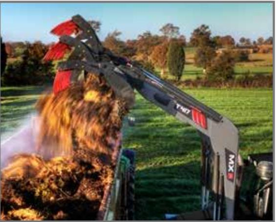
比類なきダンピング速度とユニークな非対象ラムシリンダーにより、最高のパフォーマンスを実現
