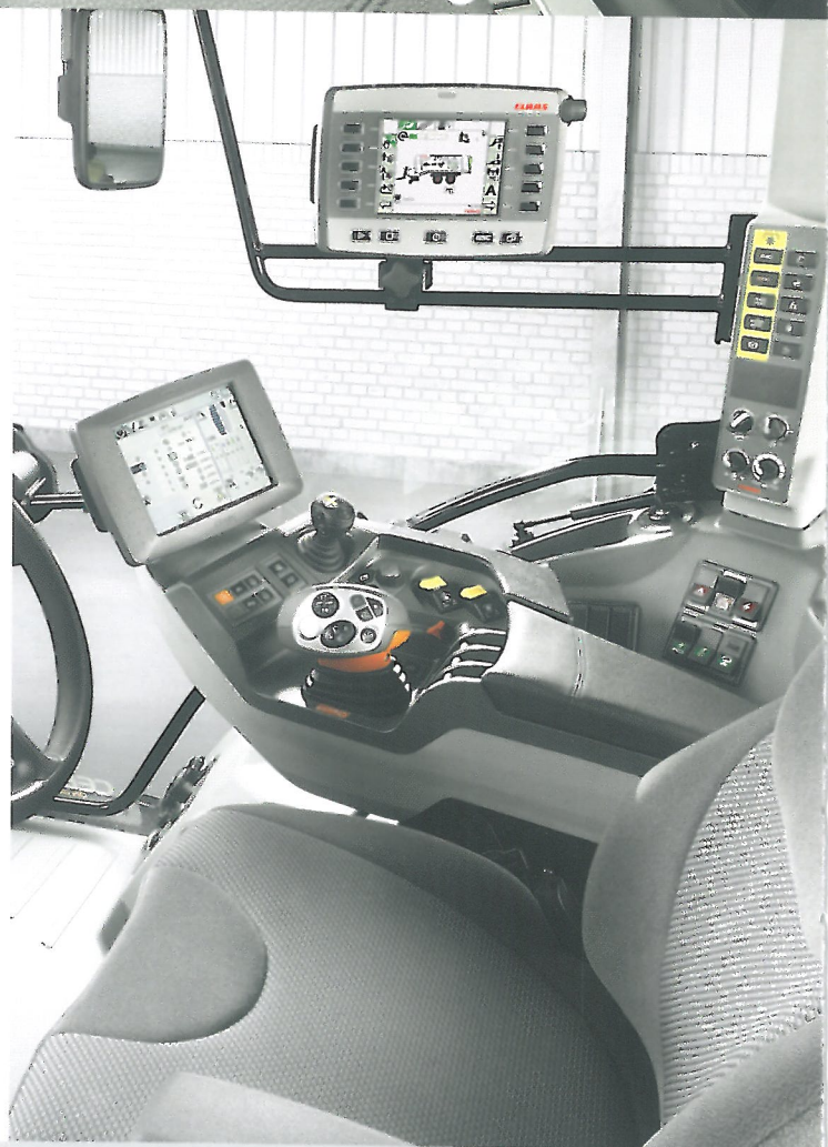
アームレストのコントロールパネル (11): 4WD、ディファレンシャルロック、オートPTO起動/停止、フロントアクスルサスペンション
